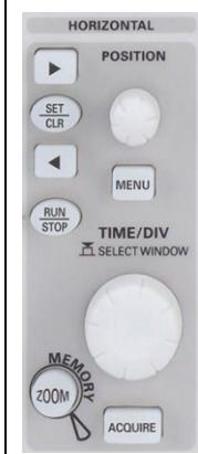
La zone **HORIZONTAL** permet de choisir les paramètres de la base de temps :
